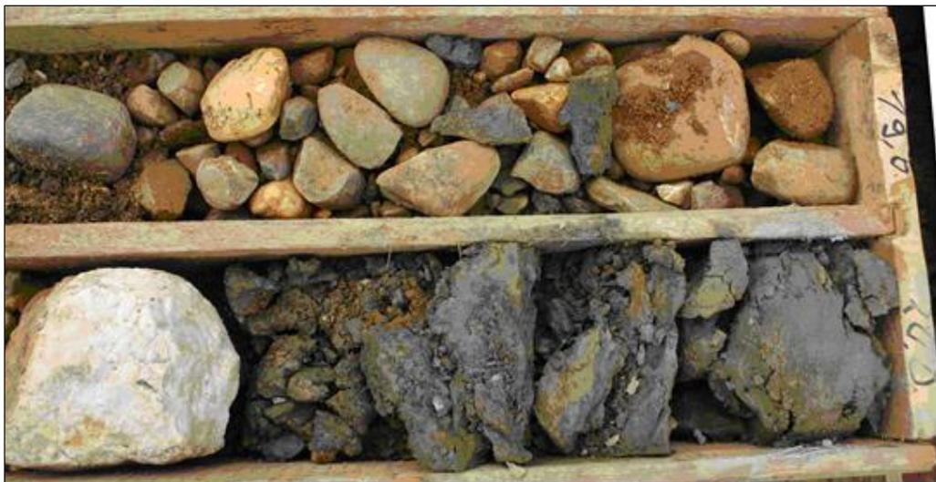
Abb. 3: Übergang der wasserspeichernden Kiese (Grundwasserleiter) in die trockenen und wasserundurchlässigen (Verwitterungs-)Tone des Schiefergebirges an der Basis der Terrassenablagerung (Grundwasserstauer) (Quelle: WASSER UND BODEN 2010).
